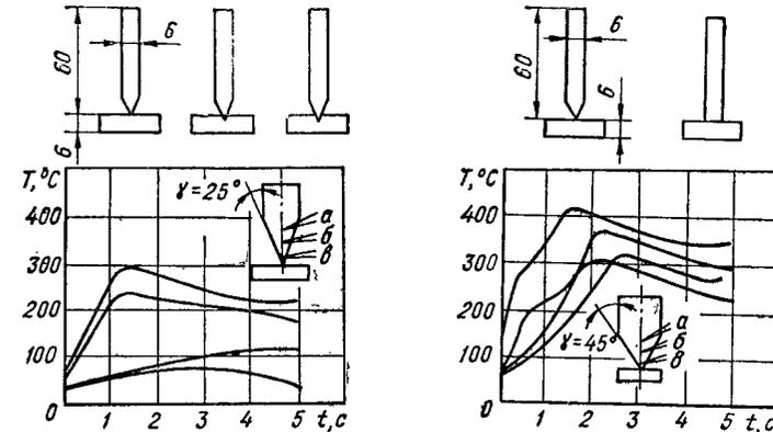
Рис. 56. Кинетика образования соединений по схеме «с преимущественным внедрением». Материал — капролон В ( $A = 45$  мкм;  $P = 220$  Н/см<sup>2</sup>;  $a, b, v$  — места расположения термопар)
