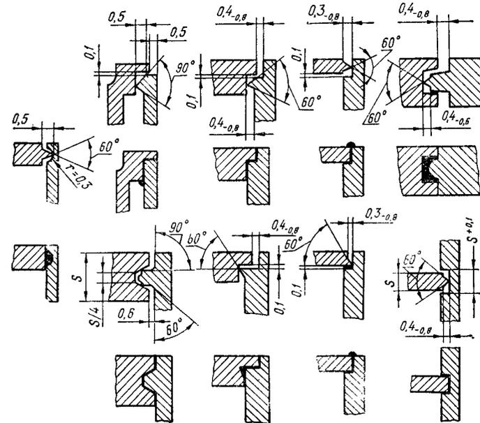
Рис. 54. Возможные типы разделки кромок жестких пластмасс при ультразвуковой сварке
