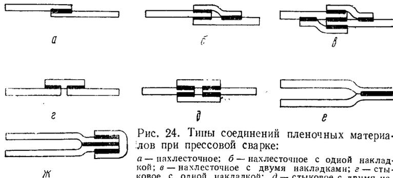
Рис. 24. Типы соединений пленочных материалов при прессовой сварке:
