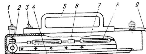
Рис. 30. Сварочный полз УСП-9:
