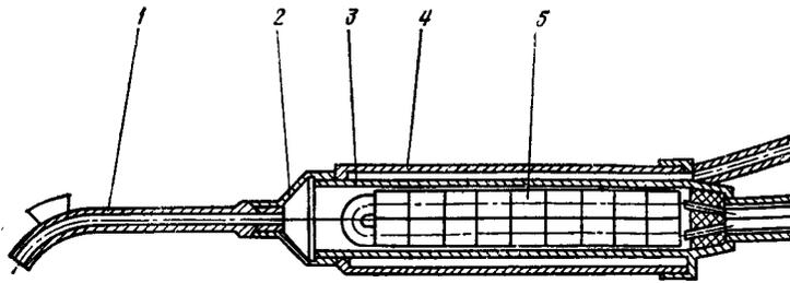
Рис. 9. Нагреватель ГСП-280 для сварки пластмасс:
