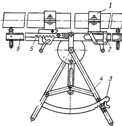
струбцина для прижима по вертикали концов сопрягаемых труб при оплавлении и сварке (рис. 16); нагревательный инструмент прямоугольной формы; фиксирующая муфта для временного закрепления концов труб, подлежащих сварке во вторую очередь и возможности смещения трубной вставки на необходимое расстояние в вертикальной плоскости; опоры; ручная ножовка [35].
