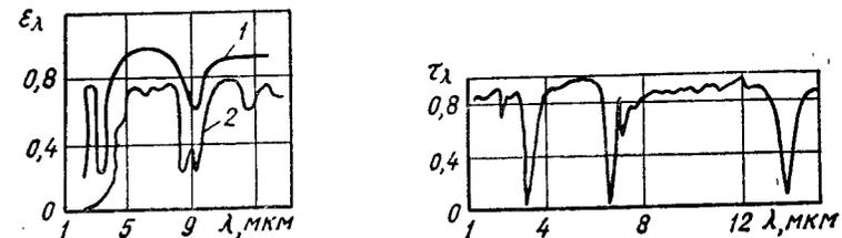
Рис. 72. Спектральные коэффициенты излучения кварцевого стекла: 1 — толщина 1,6 мм,  $T = 511$  °С; 2 — толщина 2 мм,  $T = 200$  °С
