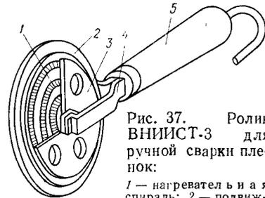
Рис. 37. Ролик ВНИИСТ-3 для ручной сварки пленок:
