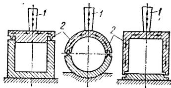
кового поля по высоте. Для выбора оптимальных размеров свариваемых деталей по высоте последние должны рассматриваться как составная часть акустической системы преобразователь — волновод — детали — опора и удовлетворять условиям [32]  $l_1 = (2m + 1)\lambda/4$ ;  $l_2 = k\lambda/2$ , где  $l_1$  — длина верхней детали;  $l_2$  — длина нижней детали;  $\lambda$  — длина волны в материале деталей;  $m = 0, 1, 2, \dots$ ;  $k = 0, 1, 2, \dots$
