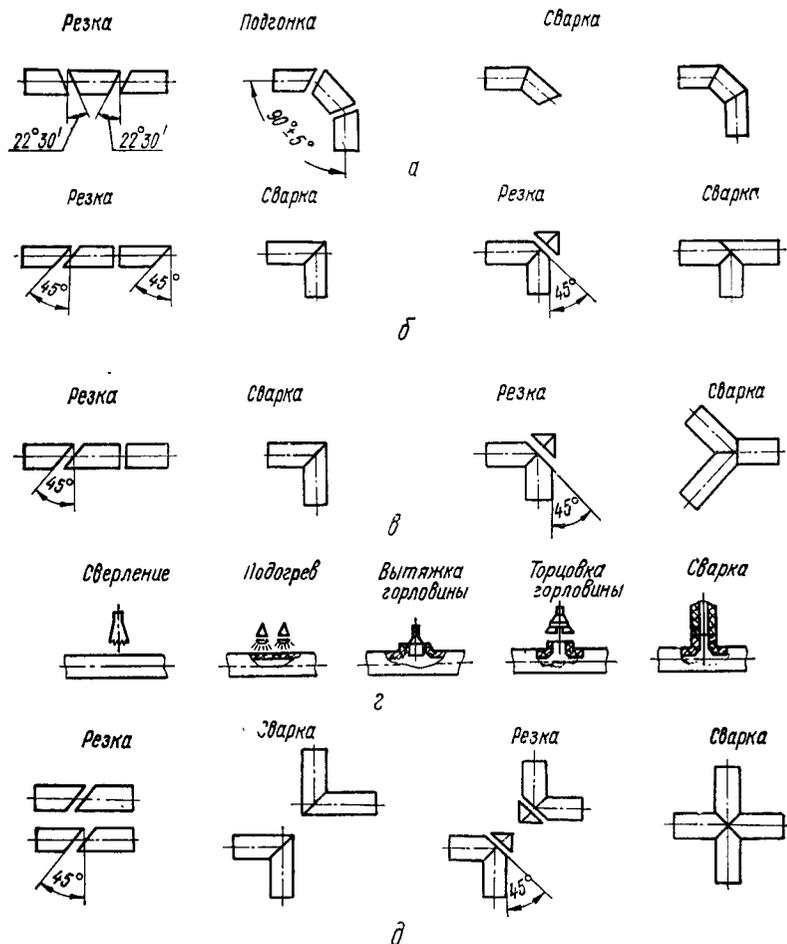
Рис. 12. Схема изготовления сварных соединительных деталей пластмассовых трубопроводов:
