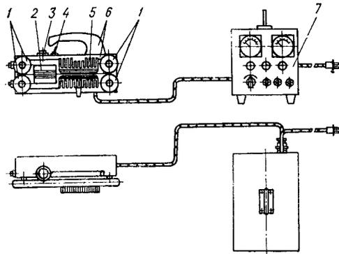
Рис. 34. Полуавтомат ПСП-15М для сварки термопластичных пленок:
