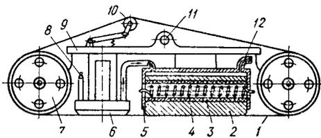
Рис. 31. Верхняя сменная сварочная головка машины МСП-5У:
