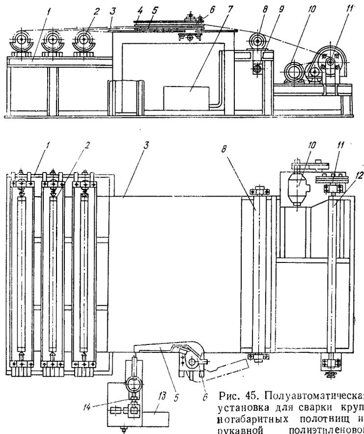
Рис. 45. Полуавтоматическая установка для сварки крупногабаритных полотнищ из рукавной полиэтиленовой пленки
