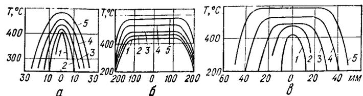
Рис. 80. Распределение температуры на поверхности нагреваемого материала по ширине (а) и длине (б) от одиночного излучателя с нагревательным элементом шириной 5 мм (1), 10 мм (2), 20 мм (3), 30 мм (4), 40 мм (5); по ширине (г) от спаренного излучателя с нагревательными элементами шириной 10 мм и зазором между ними 2 мм (1), 4 мм (2), 6 мм (3), 8 мм (4), 10 мм (5)
