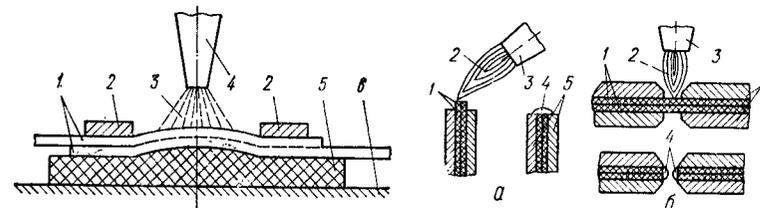
Рис. 6. Схема сварки нагретым газом пленочных материалов:
