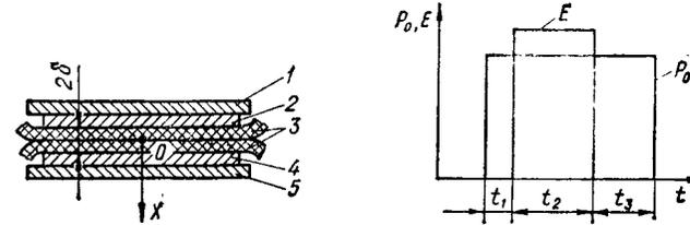
Рис. 59. Схема высокочастотной сварки
