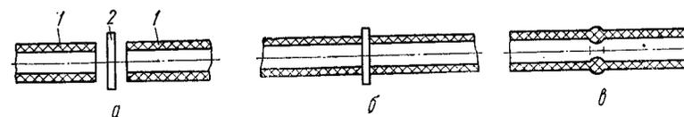
Рис. 11. Последовательность процессов стыковой сварки нагретым инструментом:
