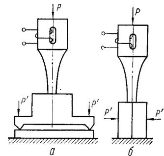
При ультразвуковой сварке по деформационному критерию задается фиксированная осадка материала, фиксированный зазор между инструментом и опорой или толщина шва. При сварке с фиксированной осадкой необходимо,
