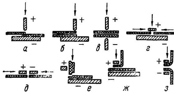
Рис. 64. Примеры взаимного расположения соединяемых изделий и варианты размещения электродов при сварке:
