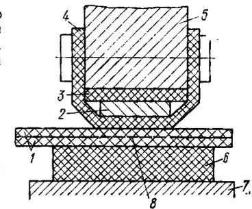
Рис. 28. Схема термоимпульсной сварки полимерных пленок:
