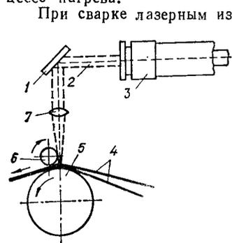
При сварке лазерным излучением используются газовые  $\text{CO}_2$ -лазеры с длиной волны 10,6 мкм марок ЛГ-17, ЛГ-22, «Катунь», рассчитанные на непрерывный режим работы и имеющие мощность соответственно 25, 40 и 800 Вт, а также марки ТИЛУ с импульсным режимом работы и средней мощностью 2 кВт [22].
