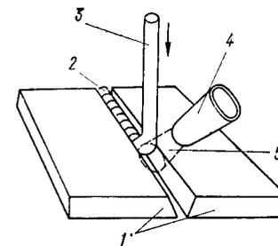
Рис. 2. Схема сварки пластмасс нагретым газом с применением присадочного материала:
