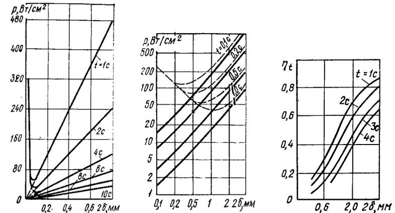
Рис. 61. Зависимость удельной мощности  $p$ , отнесенной к  $1 \text{ см}^2$  поверхности шва, от полной толщины материала  $2\delta$  для различных значений времени нагрева  $t$  при сварке жесткого ПВХ
