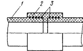
Рис. 38. Соединение труб с раструбной втулкой сваркой остающимся в шве нагретым элементом в виде спирали:
