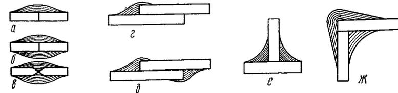
Рис. 86. Типы соединений приформовкой:
