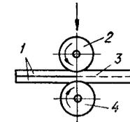
Рис. 36. Схема роликовой сварки с односторонним нагревом:
