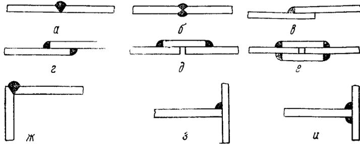
Рис. 3. Основные типы сварных соединений:
