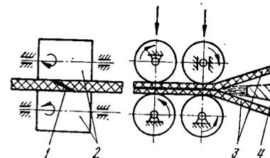
сторонним нагревом внешней поверхности пленок по месту шва (косвенным нагревом) и оплавлением пленок по месту их соединения. [10,15]
