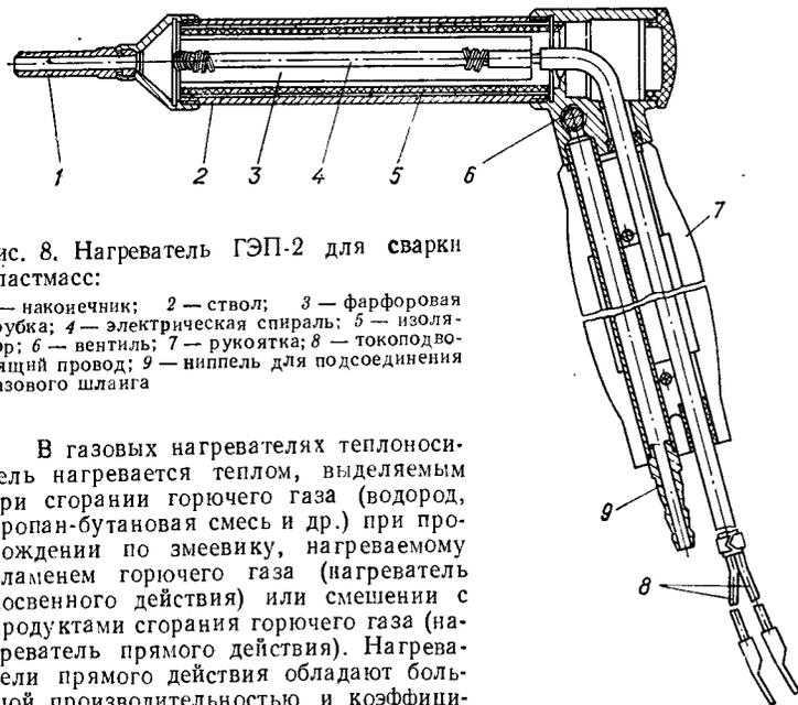
Рис. 8. Нагреватель ГЭП-2 для сварки пластмасс:
