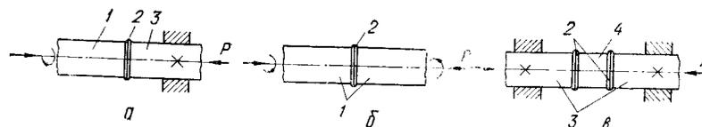
Рис. 48. Принципиальная схема сварки трением с использованием вращения одной детали (*а*), обеих деталей (*б*), вставки (*в*): 1 — вращающаяся деталь; 2 — сварной шов; 3 — неподвижная деталь; 4 — вставка
