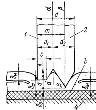
Для получения сварных швов с различной конфигурацией широкое распространение находят электроды, представленные на рис. 66. При работе с указанными электродами с целью исключения электрического пробоя электрод, совмещенный с нижней плитой сварочного пресса, рекомендуется покрывать листом материала, имеющим высокие диэлектрические характеристики, например гетинаксом.
