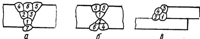
Рис. 4. Порядок укладки сварочных прутков в шов: а — стыковой V-образный шов; б — стыковой X-образный шов; в — нахлесточное соединение
