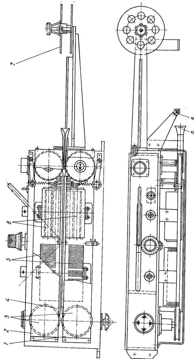
Рис. 33. Верхняя сменная сварочная головка полуавтомата УСПП-3М:
