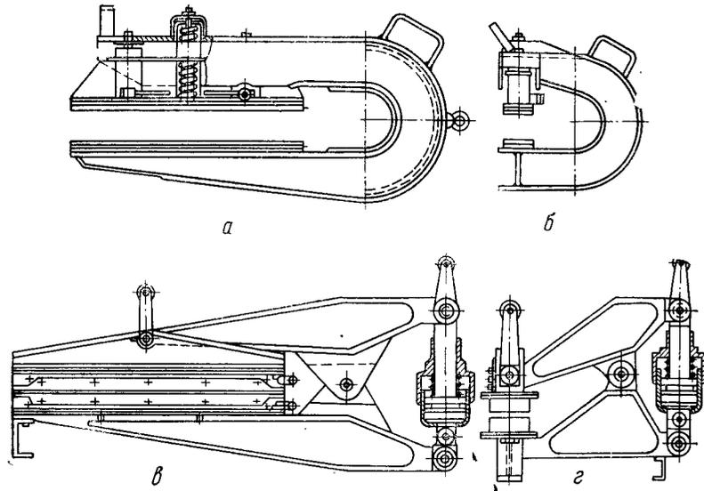
Рис. 25. Переносные скобообразные прессы типа ССП: а — ССП-5, неразъемный для сварки продольных швов; б — ССП-4, неразъемный для сварки поперечных швов; в — ССП-7, разъемный для сварки продольных швов; г — ССП-6, разъемный для сварки поперечных швов
