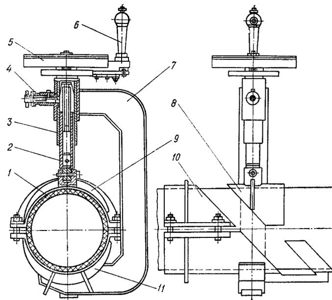
Рис. 16. Струбцина для сварки труб в косой стык:
