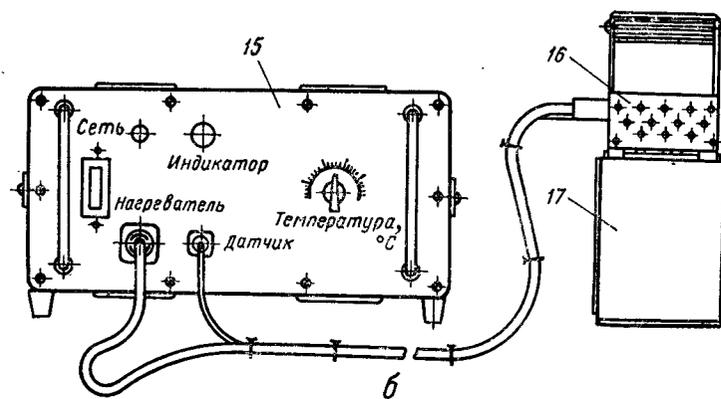
Рис. 14. Установка УСТТ-110 для стыковой сварки пластмассовых труб:
