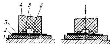
Рис. 65. Стыковая высокочастотная сварка листового пластика на упругой нетермопластичной прокладке: 1 — подложка; 2 — свариваемый материал; 3 — упругая нетермопластичная прокладка; 4 — диэлектрический корпус; 5 — сварочные электроды; б — технологическое пространство
