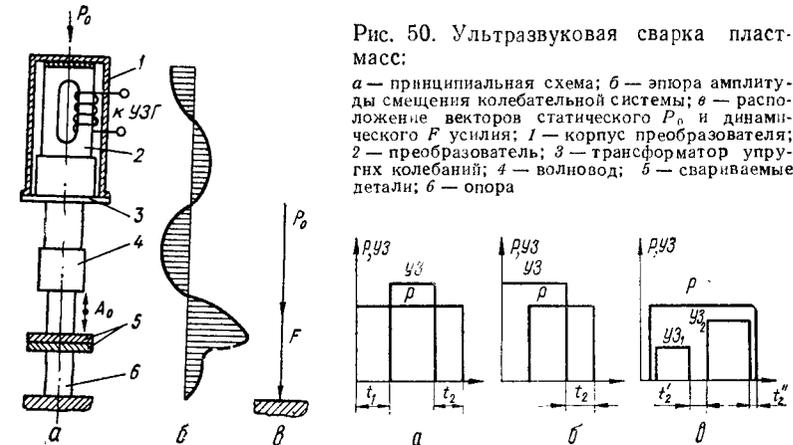
Рис. 50. Ультразвуковая сварка пластмасс:
