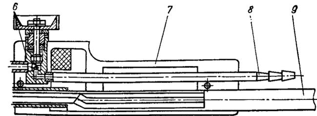
6 — узел регулировки расхода газа-теплоносителя; 7 — ватальный элемент; 8 — штуцер; 9 — кабель питания
