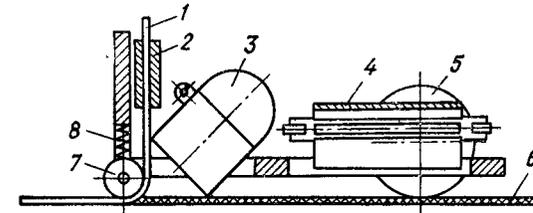
Рис. 81. Схема сварки световым излучением листового термопласта с применением присадочного материала:
