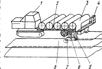
Рис. 44. Общий вид механизированной установки для изготовления противофильтрационных экранов из полимерной пленки
