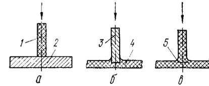
Рис. 22. Схема сварки в паз: *a* — нагрев торца; *b* — формирование паза; *в* — запрессовка листа в паз
