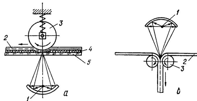
Рис. 70. Способы сварки полимерных материалов излучением; а — подвод излучения к наружной по отношению к сварочной зоне поверхности; б — подвод излучения к соединяемым поверхностям; 1 — источник излучения; 2 — свариваемый материал; 3 — прижимной ролик; 4 — прокладка; 5 — прозрачная для излучения опора
