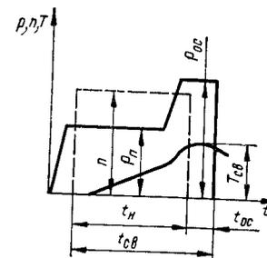
Рис. 49. Циклограмма изменения параметров режима сварки трением
