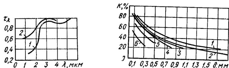
Рис. 76. Степень поглощения ИК-лучей поливинилхлоридом толщиной 0,3 (1) и 3,2 мм (2)
