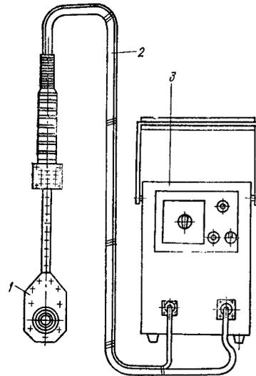
Рис. 19. Устройство УСТТР-50 для раструбной сварки пластмассовых труб:
