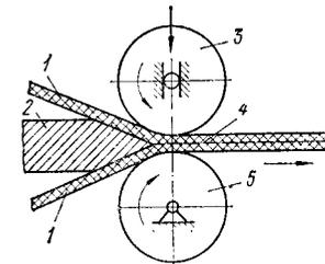
Рис. 20. Схема сварки нагретым клином нахлесточных соединений пленок:
