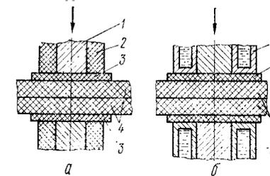
Рис. 23. Схема прессовой сварки с нагревательным инструментом без охлаждения (*a*) и с охлаждением (*b*) боковых зон шва:
