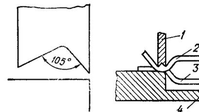
Рис. 68. Форма сварочной кромки электрода для безоблойной сварки
