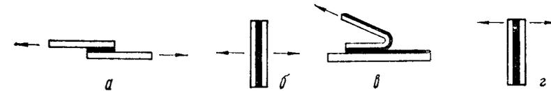
Рис. 83. Основные типы нагружения клеевого соединения:
