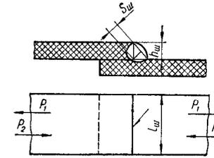
Рис. 88. Нахлесточное соединение
